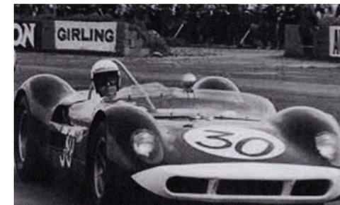
za e potevano essere ordinate in kit alla Attila Cars di Molesey Road, Hersham, Surrey, Dare Bryan e Pierpoint alzarono il tiro. E con un impegnativo adattamento del telaio per portare il motore alle spalle del pilota e non più in posizione anteriore, progettaron una versione dotata del più economico propulsore Ford V8 289, con una carrozzeria ispirata alla Lotus 30. L'elaborazione era stata affidata Holman
